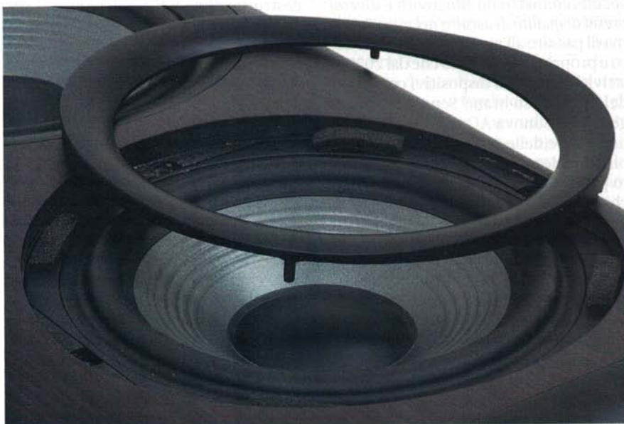
Le ghiera di rifinitura applicate sui woofer sono fissate a pressione e si appoggiano su quattro striscioline adesive in foam. Queste striscioline coprono le teste delle viti di fissaggio ed evitano che le ghiera entrino in vibrazione durante la riproduzione.
