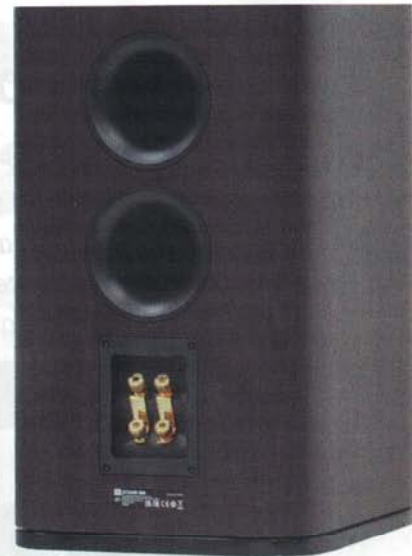
La parte posteriore degli Studio 690 mette in risalto i due condotti di accordo e i morsetti d'ingresso con ponticelli asportabili per l'eventuale pilotaggio in bi-amplificazione.
